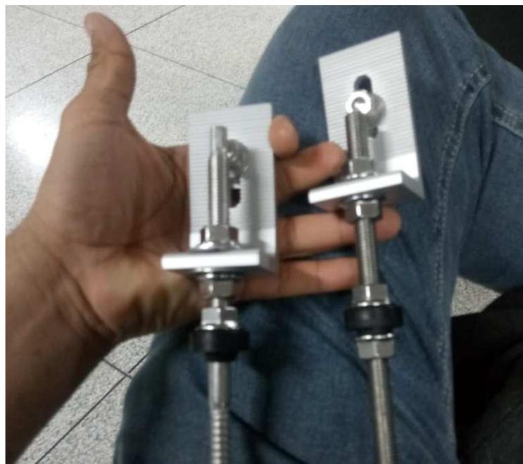
Peças de instalação de painéis fotovoltaicos apresentadas na palestra
