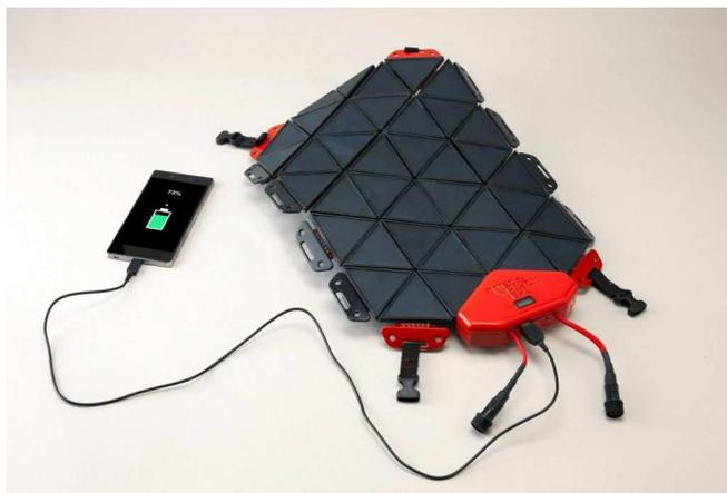
“Cada módulo é interligado por uma dobradiça condutora sem deformação mecânica quando em uso, para que ele não tenha o problema usual de dobrar apenas 5000 [vezes] antes de encaixar”, disse Brister em entrevista ao site Dezeen. “Teoricamente, o projeto pode ser flexionado e dobrado indefinidamente ou pelo menos até que as superfícies se desgastem”, completou.
